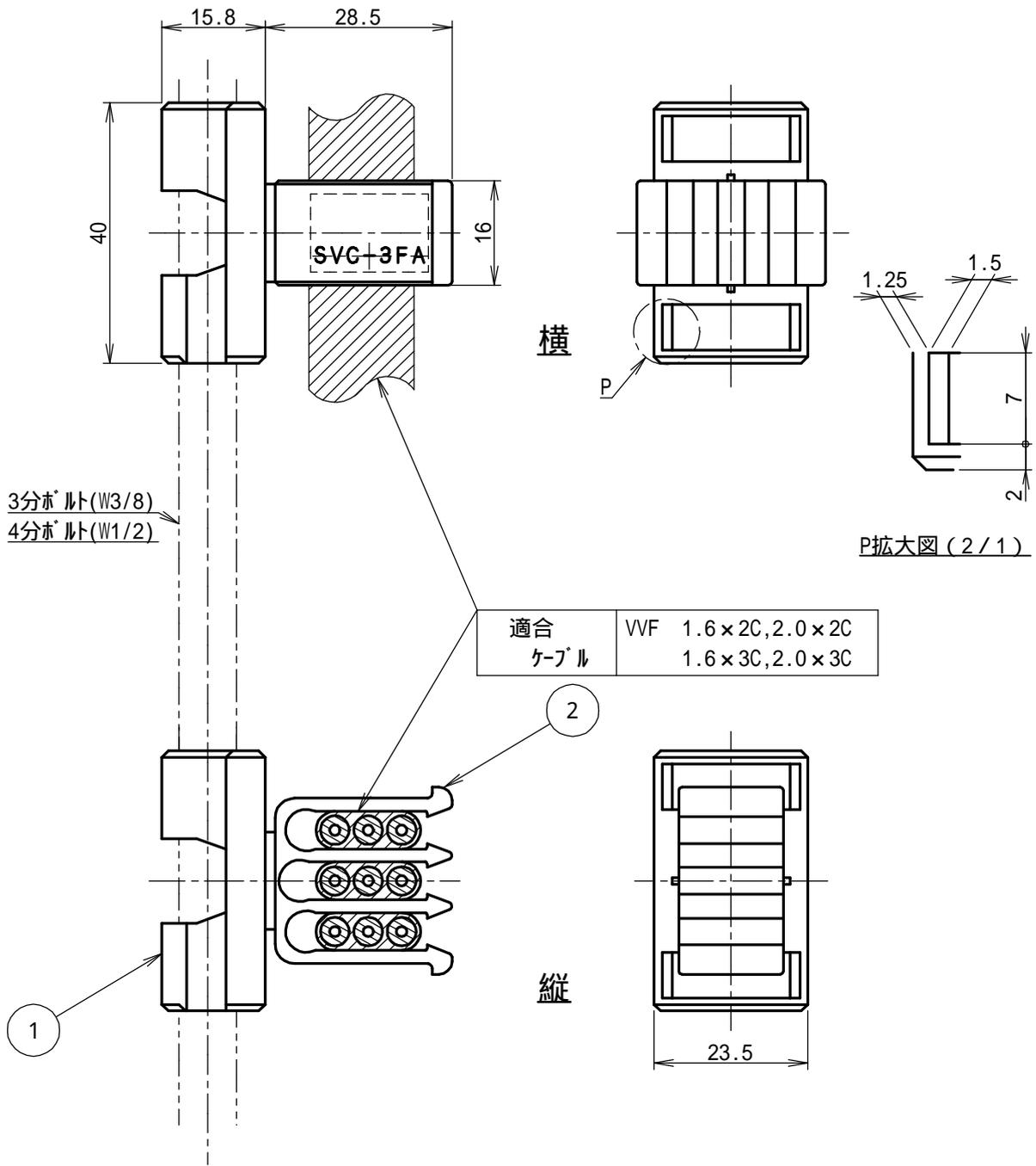
クリップ部を回転させ、縦方向、横方向、斜め45°へ自在に変換出来ます。
